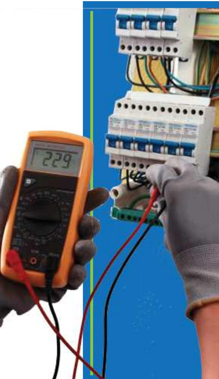
neutro del tablero principal esté realmente conectada con el neutro. Esa verificación será tanto para el TT como para el TN-S. De no colocar el neutro a tierra estaremos frente a un ECT IT que requiere dispositivos especiales de control y monitoreo (por ejemplo Monitores de aislación).
